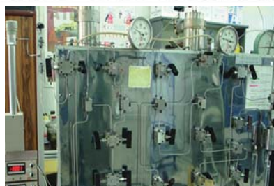
Hình 5. Mô hình và thiết bị đánh giá sự thay đổi độ thấm của mẫu lõi
