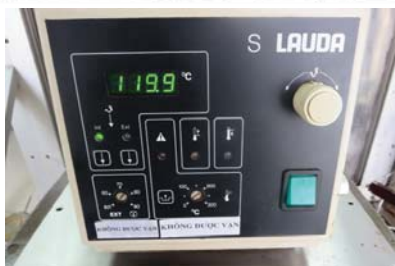
Hình 5. Mô hình và thiết bị đánh giá sự thay đổi độ thấm của mẫu lõi
