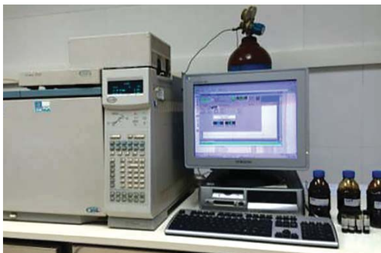
Hình 5. Thiết bị sắc ký khí Agilent 6890N tại Phòng thí nghiệm Trung tâm Nghiên cứu Tìm kiếm Thâm dò và Khai thác Dầu khí, Viện Dầu khí Việt Nam
