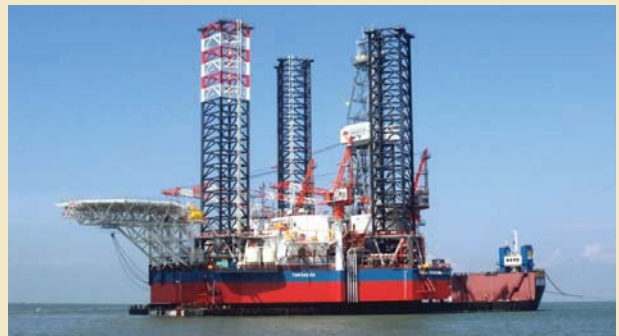
Giàn khoan tự nâng 90m nước Tam Đảo 03. Ảnh: PV Shipyard
